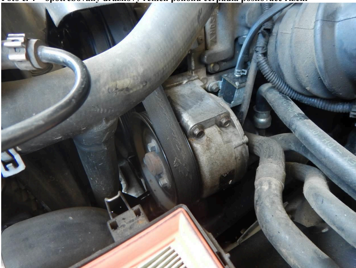
Foto č. 4 – opotřebovaný drážkový řemen pohonu čerpadla posilovače řízení
