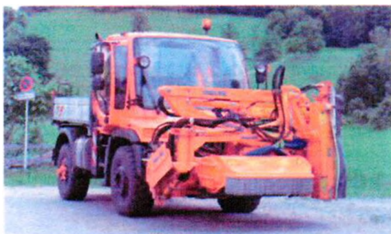
Tandemová sekačka MULAG MKF 600 – přepravní poloha
