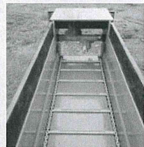
Řetězový podlahový dopravník posouvá materiál k rozmetacímu ústrojí
