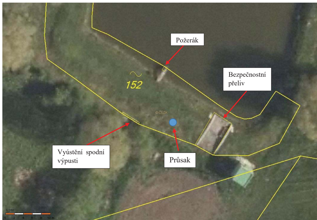
Obrázek 2. Situace hráze s vyznačením místa průsaku na vzdušní straně hráze
