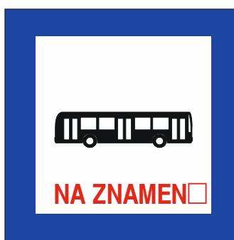
Obrázek č. 6: Vzor značky doplněné o text „NA ZNAMENÍ“ dle bodu 4.2 a) tohoto článku v případě užití na zastávce na znamení dle bodu 2.1 článku 2
