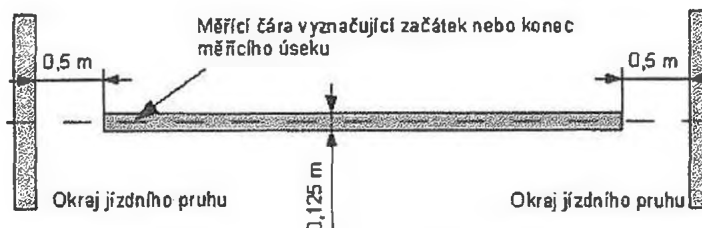
Obr. 2 Vyznačení začátku a konce měřicího úseku měřicí čarou
