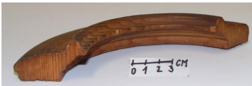
Polotovary hraček odseknuté ze soustružených prstenců EH-00537, EH-00536
