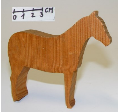
Polotovary hraček odseknuté ze soustružených prstenců EH-00537, EH-00536
