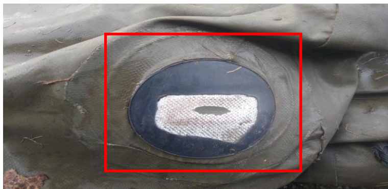
utržené kotvící oko
