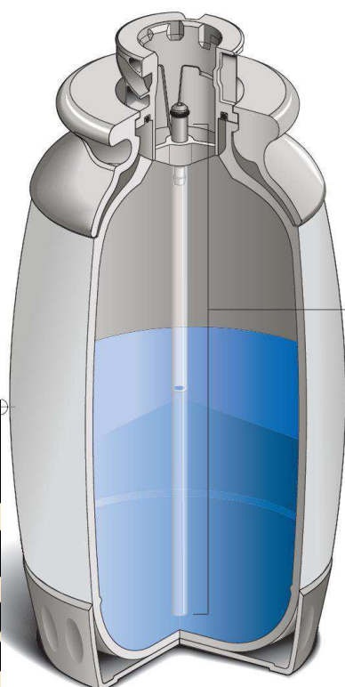
Nová láhev na chladicí vodu pro nástroje má integrovanou sací hadičku, což pomáhá snížit riziko kontaminace
