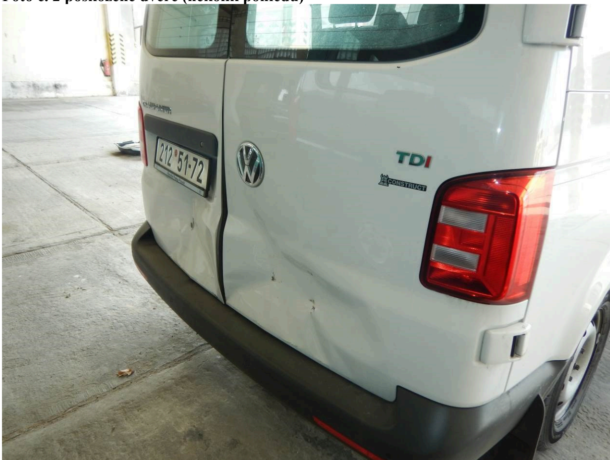
Foto č. 2 poškozené dveře (několik pohledů)
