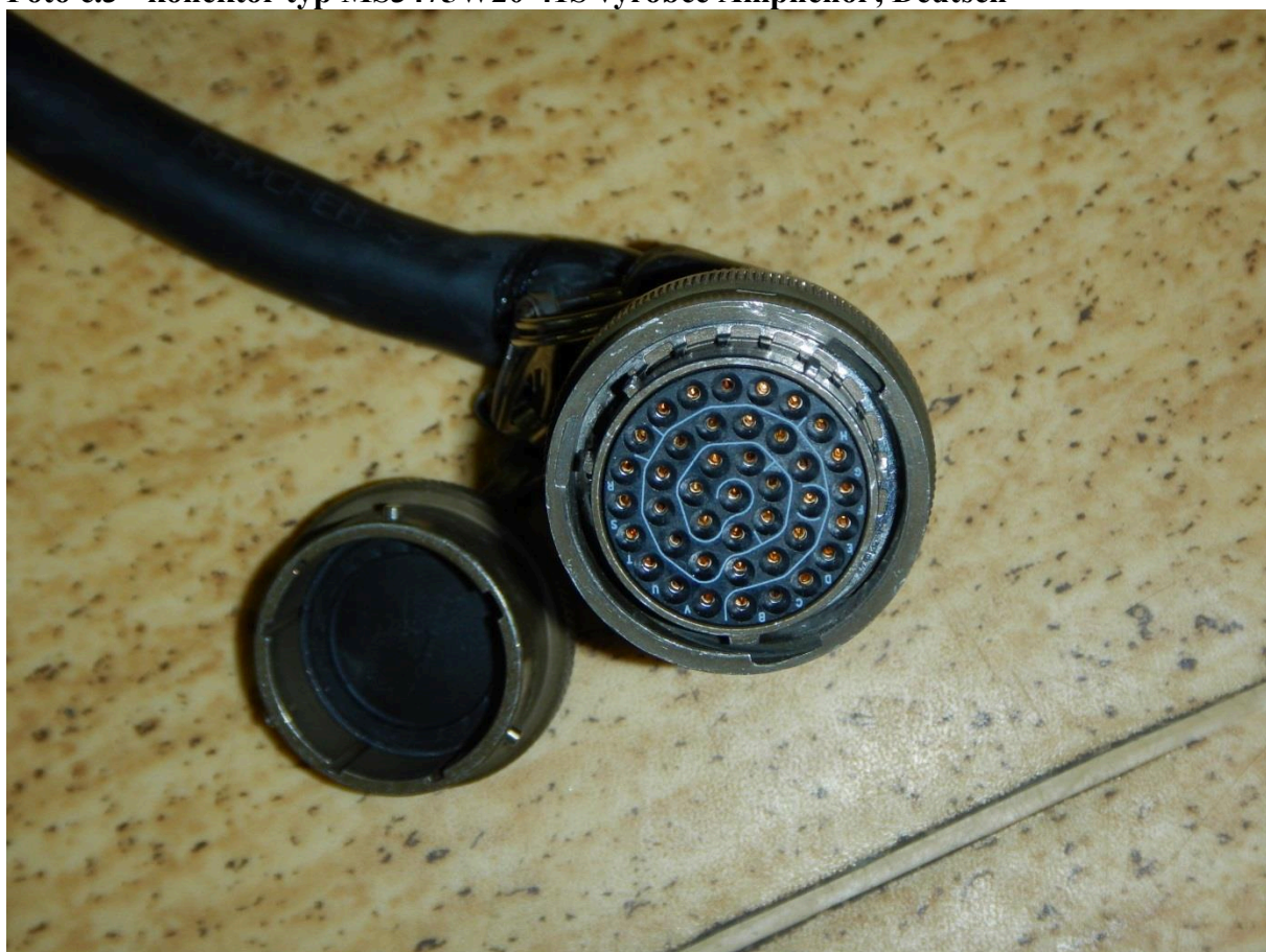
Foto č.3 - konektor typ MS3475W20-41S výrobce Amphenol , Deutsch
