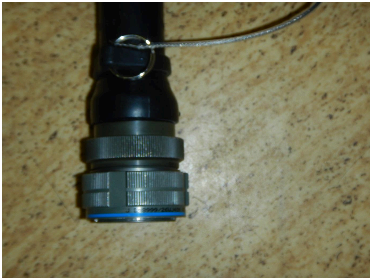
Foto č.3 - konektor typ MS3475W20-41S výrobce Amphenol , Deutsch
