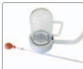
Souprava na spalování etanolu
