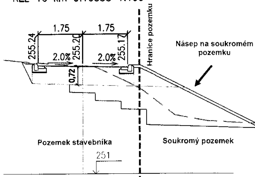
Původní řez komunikací s vyznačením náspu a jeho zásahu na soukromý pozemek
