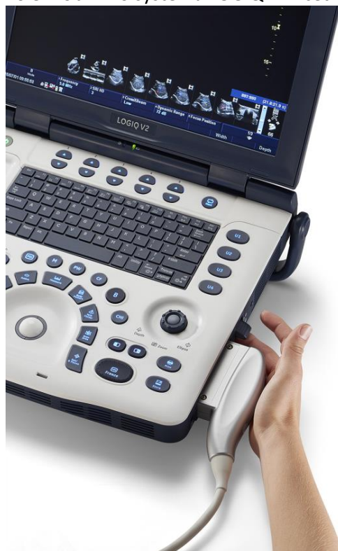
Obr. č. 3: Připojení sondy k LOGIQ V2
