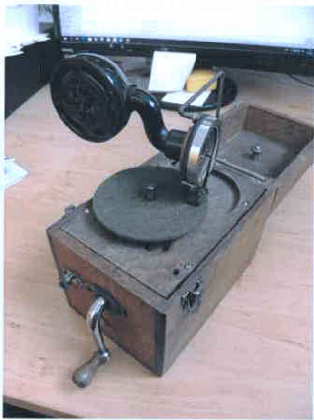
1) Piknikový mechanický gramofon Cameraphon rozložený, složený
