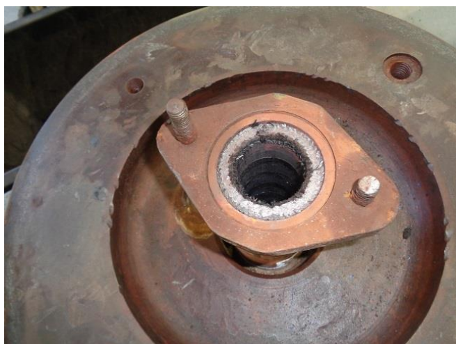
5.6.2 Vyměnit uhlíkovou ucpávku a 2 ks šroub M 10 x 50 mm za nové z mat. 15320.6
