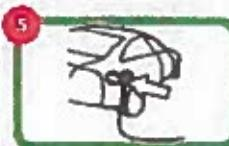
Vložte přípojku do plnicího traktu vozidla.
