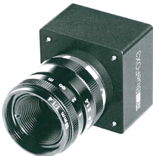
Obr. 1 - použitá průmyslová kamera bez venkovního krytu
