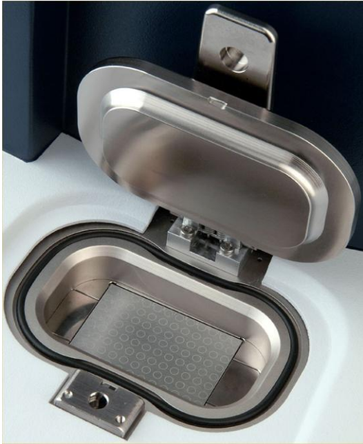
Obrázek 3-6: Vstupní port s terčikem typu Micro SCOUT
