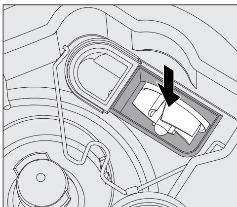
Pod zpětným ventilem je umístěné oběhové kolo vypouštěcího čerpadla (šipka).
