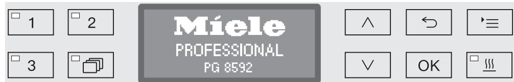
Jakmile je mycí automat připravený k provozu, změní se zobrazení na displeji a zobrazuje se na něm naposledy zvolený program, např.:
