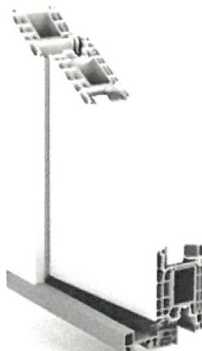
Dveře CLASSIC 76 - 5 komorový profil 76mm se sendvičovou výplní 24mm U_p = 1,1 \text{ W.m-2.K-1} a izolačním dvojsklem U_g = 1,1 \text{ W.m-2.K-1} Celkové U_d \leq 1,2 \text{ W.m-2.K-1}
